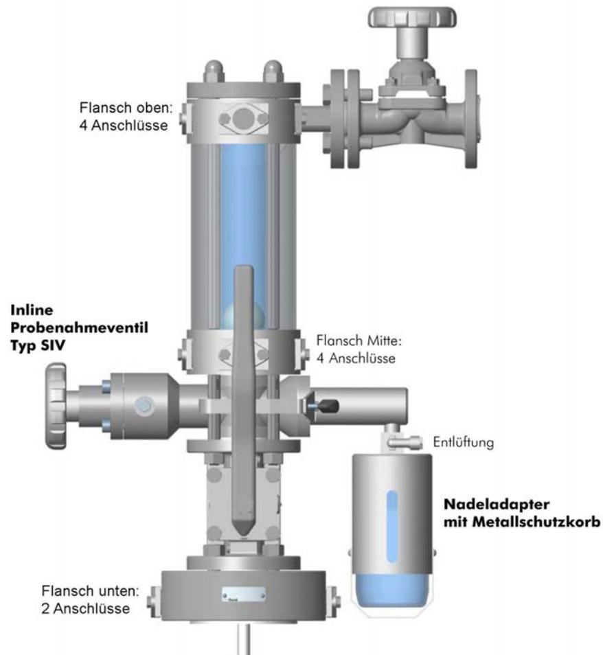
Anstelle des Bypasses wird das Probenahmeventil Typ SIV eingebaut. Bei dieser Variante entfällt die Gaspendelleitung, die Rückleitung erfolgt beim SIV über den Entlüftungsanschluss im 90°-Winkel-adapter an die Atmosphäre oder in einen Aktivkohlefilter. Mittels Nadeladapter und Flasche mit Septum kann die Probenahme kontaminationsfrei (100% geschlossen) erfolgen.
